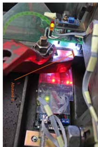
Optische Messeinheit zur Detektion der Zungenprüfereinstellung in einem S700-Antrieb
