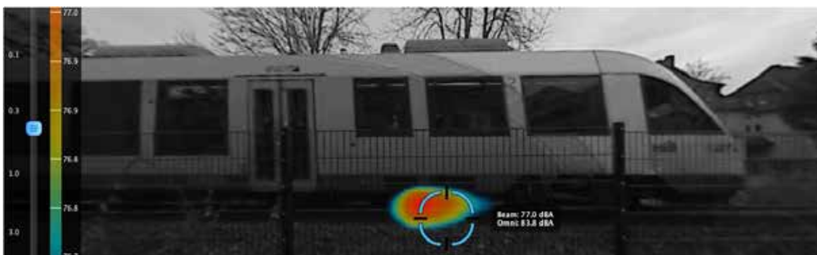
Messaufnahme ohne LSW bei einem vorbeifahrenden Personenzug
